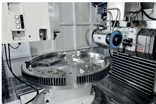
Высокоточная шлифовка зубчатого колеса на современном зубошлифовальном станке
