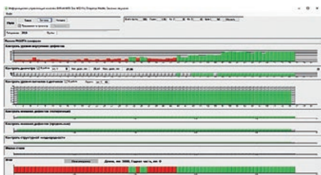
Результат контроля прутка с внутренним протяженным дефектом
