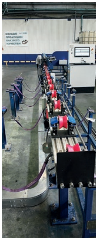
Информационно-управляющий комплекс в комплекте со сканирующим устройством и оборудованием механизации
