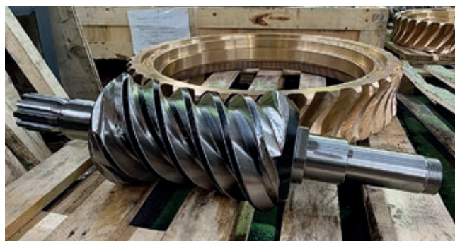
Многозаходный точно отшлифованный глобоидный червяк и бронзовое червячное колесо после их механической обработки
