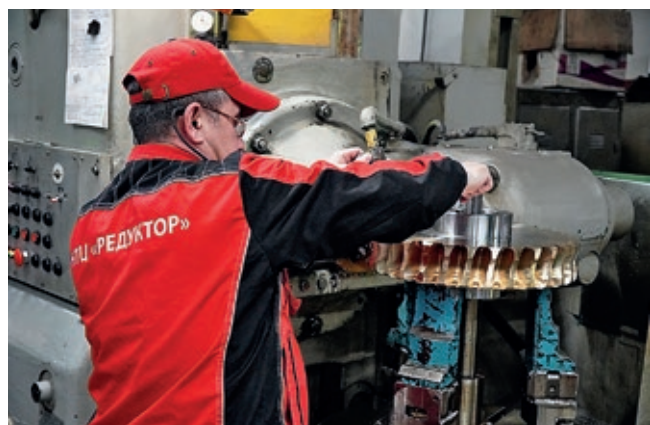
Момент снятия нарезанного червячного колеса с зуборезного станка
