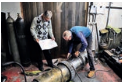
НТЦ «РЕДУКТОР» выполнил ремонт вальшестерни длиной 1800 мм в сборе с колесом, диаметр которого 1500 мм. Вес сборной конструкции достигал 7,5 т. На снимке: Сотрудники НТЦ «РЕДУКТОР» обсуждают технологию ремонта вала
