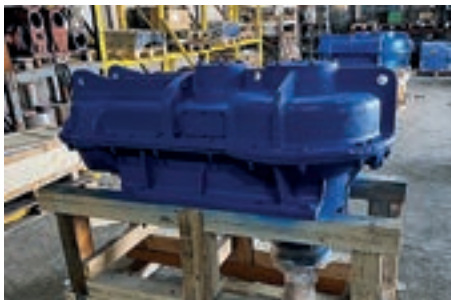
Редуктор КДВ-350, изготовленный в НТЦ «РЕДУКТОР». Используется в подвесных грузонесущих и толкающих конвейерах
