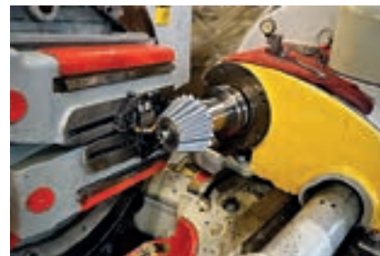
Изготовление конической передачи для редуктора
