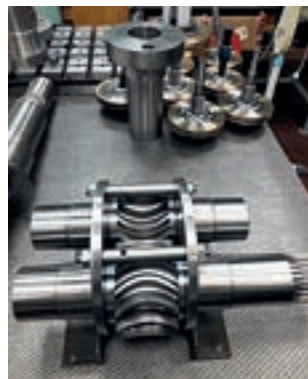
Продукция, производимая в НТЦ «РЕДУКТОР»: червячные и арочные передачи
