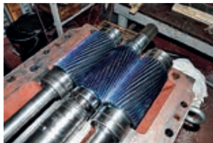
НТЦ «РЕДУКТОР» отремонтировал редуктор фирмы Flender для экструдера термостата модели KMD 90 XS/1 фирмы KRAUSS-MAFFI. На снимке проверка пятна контакта на зубе
