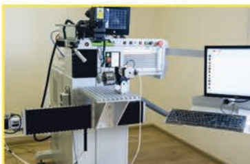
ЛАЗЕРНАЯ СВАРКА МЕЛКОРАЗМЕРНЫХ ДЕТАЛЕЙ
