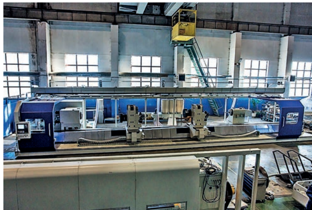
Многофункциональный токарный обрабатывающий центр «Саста» с двумя проходными суппортами
